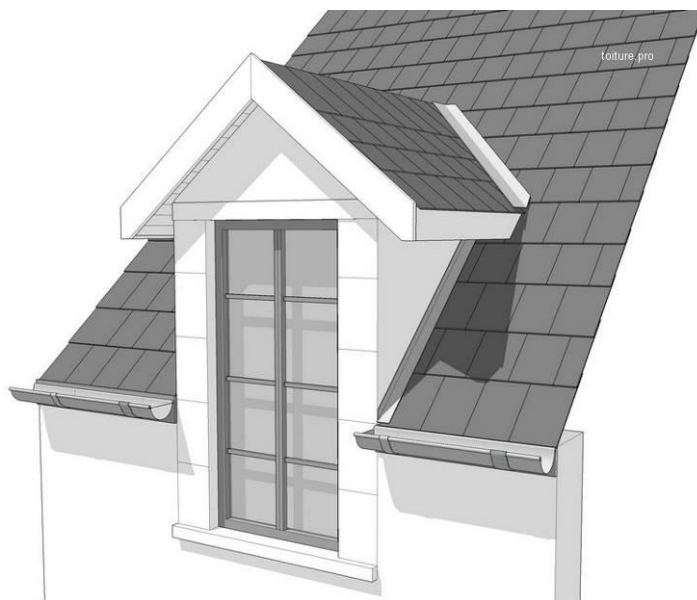
Schéma d'une lucarne gerbière source : toiture.pro
